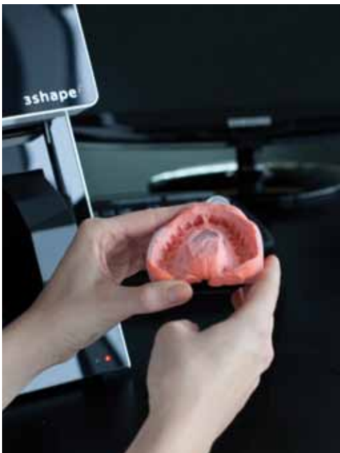
Fig.4 - Possibilidade de digitalizar as impressões em alginato ou silicone, obtendo de seguida o modelo virtual.
