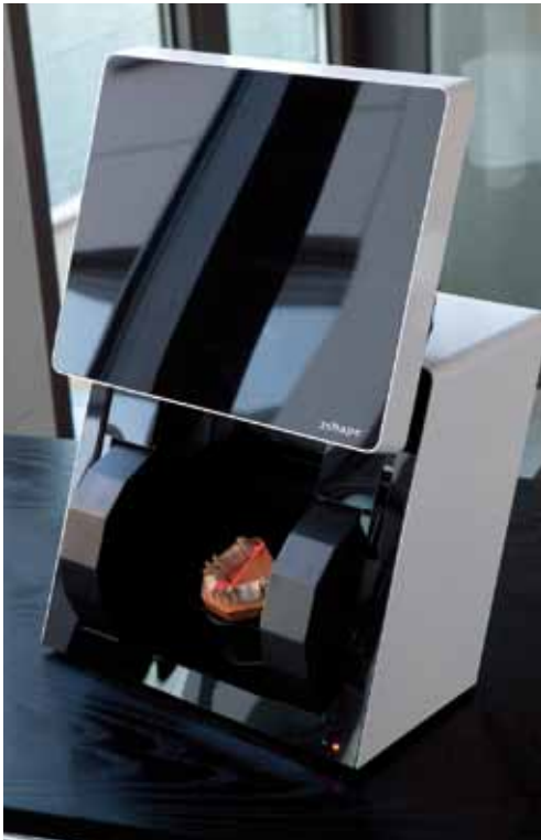
Fig 2 a- Depois da digitalização dos modelos superior e inferior, é feita a digitalização dos modelos em oclusão. Basta agora escolher alguns pontos para alinhar os modelos virtuais.
